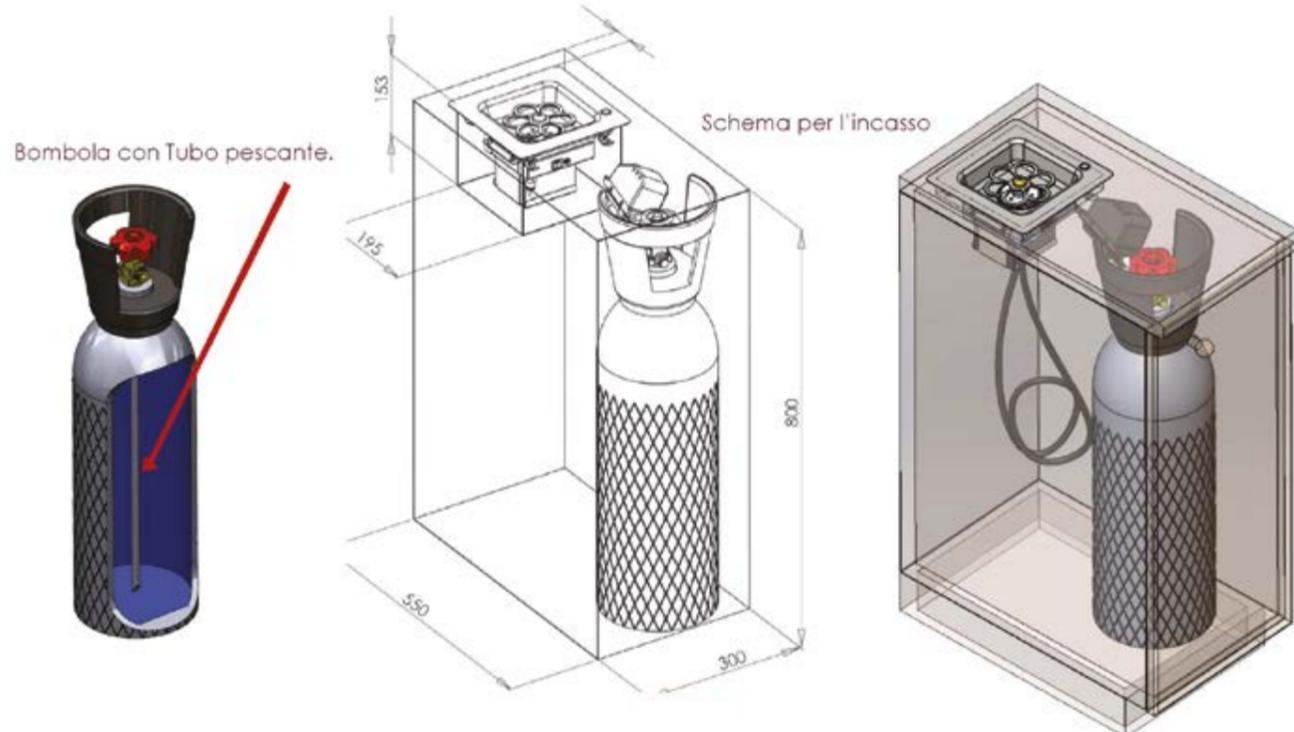
**Sistema di alimentazione E.R.T. (8 - 12 metri)**
